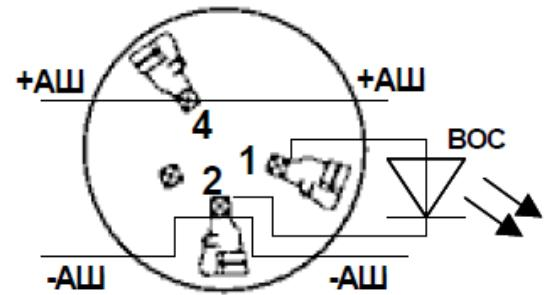
Рис. 1. Подключение базового основания SF-B1
